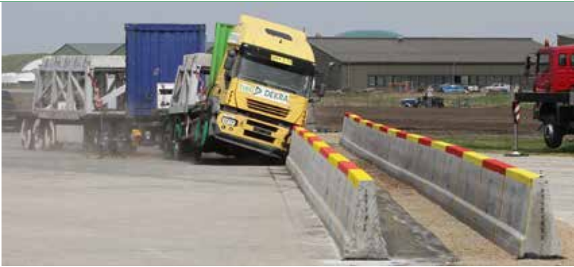
■ Testes de colisão de veículos longos pela DEKRA, mediante solicitação da Agência Federal dos Transportes: o veículo longo de 38 toneladas não quebrou a barreira de segurança de betão de duas camadas do nível mais alto de contenção.
